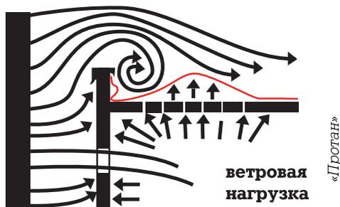
Создаваемые ветром переменные нагрузки могут привести к повреждению мембраны. Для того чтобы этого не произошло, необходимо тщательно рассчитывать количество точечных крепежных элементов либо применять реечное крепление, где нагрузка распределяется более равномерно.
